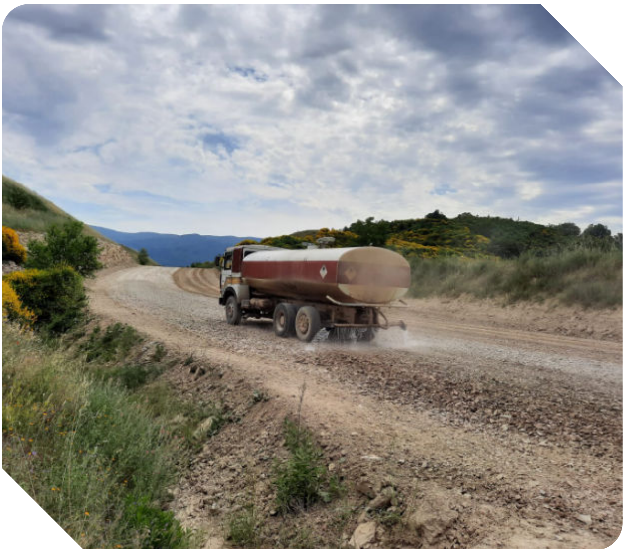
Camion con sistema di abbattimento polvere lungo le strade interne alla miniera Begliano (AR). E' un metodo semplice utilizzato in molte attività estrattive (camion con botte, o cisterna/cassone del camion e irrigatori in uscita).
